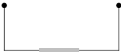
Figura 4 - Modelo idealizado do chassi com duas massas ligadas por uma mola de torção
